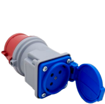
מק"ט: 5P16A-PIL מספר פאזות: 5P (3P+N+E) זרם: 16A דרגת איטמות: IP44
