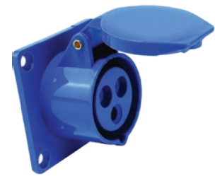
מק"טים: 3P16A-PS, 3P32A-PS 3P (2P+E) 16A זרם, 32A זרם IP44 דרגת איטות
