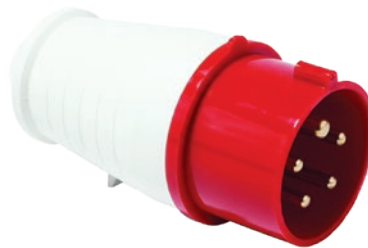
מק"טים: 5P16A-MP, 5P32A-MP 5P (3P+N+E) 16A זרם, 32A זרם IP44 דרגת איטות
